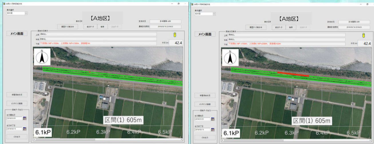
【表示画面例：左1mの検知、右100mの検知・・・侵食の広がりを実時間で把握】
